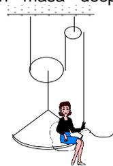
8. Una persona de 600 N de peso está sujeta a una polea que puede deslizarse a lo largo del cable inextensible de 5 m de longitud, cuyos extremos A y B están fijos a los árboles separados 4 m entre sí. En condiciones de equilibrio halle el módulo de la tensión del cable (en N).
