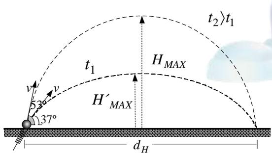
El lanzamiento de un cuerpo con la misma rapidez bajo ángulos complementarios determina el mismo alcance horizontal sobre una superficie horizontal.
