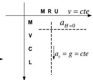
De lo observado podemos concluir que al despreciar los efectos del aire sobre el proyectil, éste experimenta un movimiento de caída libre.
