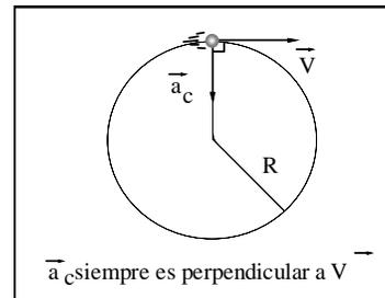
En forma general, cualquier movimiento en el cual varíe la dirección de la velocidad existirá una aceleración centrípeta.
