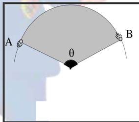
En el diagrama se muestra un MCU en el cual la partícula ha girado desde A hacia B barriendo un ángulo central "θ" y empleando un tiempo "t", luego: la relación entre el ángulo central descrito y el tiempo necesario para recorrerlo, se denomina
